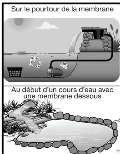
**Étape 1.** Placez le déversoir dans l'endroit choisi. Assurez-vous que ce niveau. Si le déversoir repose sur le pourtour de la membrane et que vous ne souhaitez pas fixer la membrane au déversoir, passez à la note avant l'étape 8.
